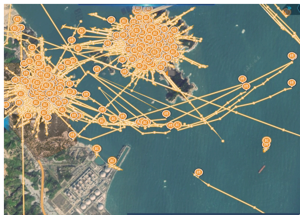
图 1 断线时刻附近的雷达及 AIS 信号 ①
