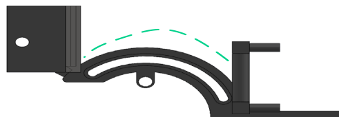
图5 弧形滑轨驱动手指康复机器人关节运动原理示意图
