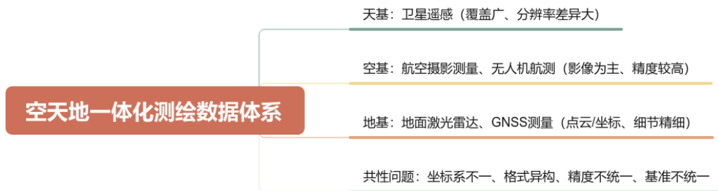
图1 空天地一体化多源测绘数据体系
