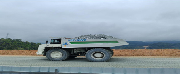
图片 2: 满载的 100 吨级纯电矿用自卸汽车 (改造车)
