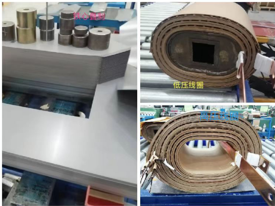
图 1 铁心叠制 - 低压线圈 - 高压线圈
