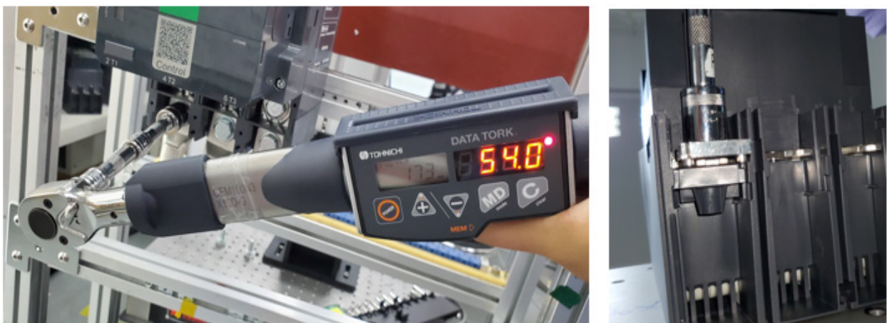
图5 M10 螺栓扭紧接线端子实验
