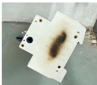
图 4 断路器烧毁参考图
