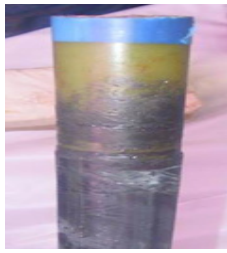
图4 电缆绝缘放电变色图片
