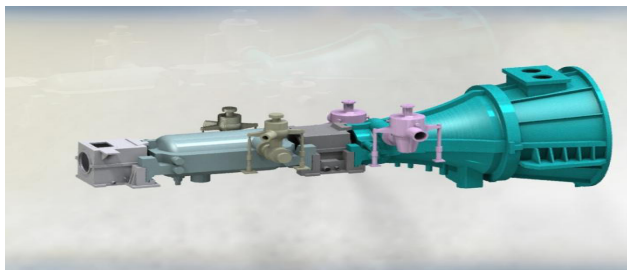
图2 100MW等级光热轴向排汽外形图
