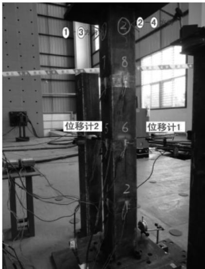
图8 轴压前期试验测量装置
