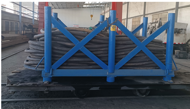
图3 电缆装载架与平板车连接紧固实现安全转运
