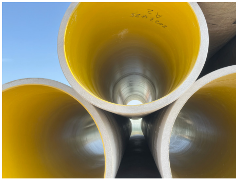
图 1 离心浇铸玻璃钢夹砂管
