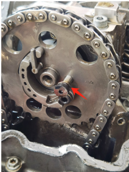
图 5 更换塞打螺栓后的凸轮轴
