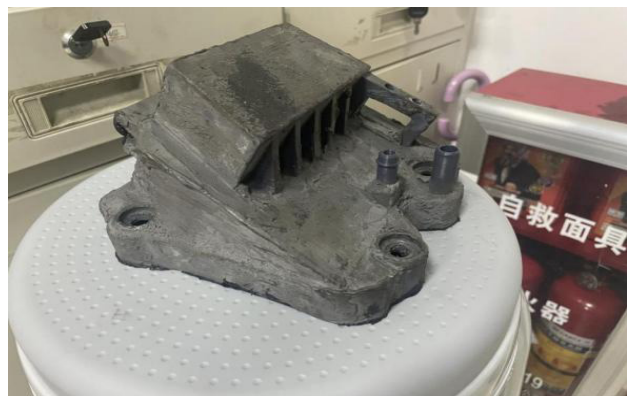
图 2 耐火涂层的 3D 打印气门室盖
