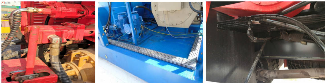
图3 修井机液气电管线防护示例
