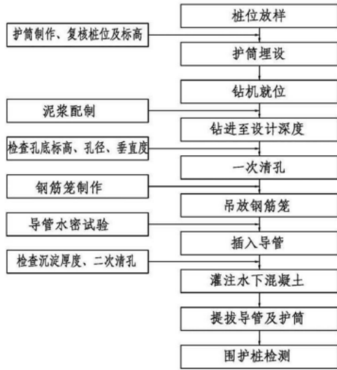
图 1 泥浆护壁钻孔灌注桩施工工艺流程
