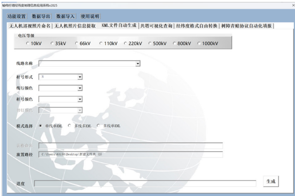
图 1 输电杆塔经纬度地理信息应用系统界面
