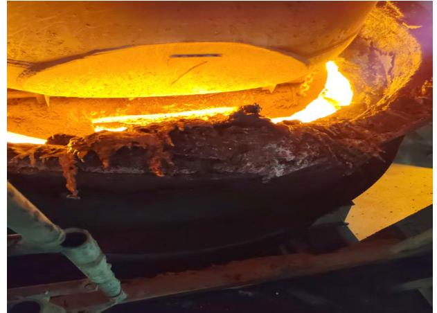
图 4 钢包包口及内壁积渣
