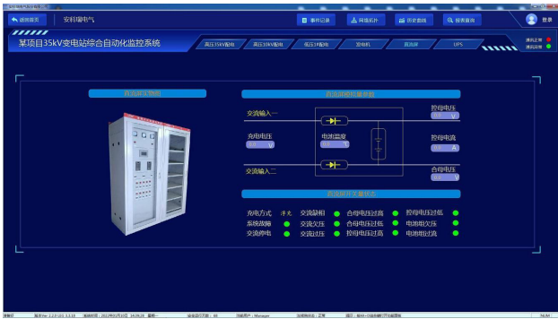
图1：某电力监控自动化系统
