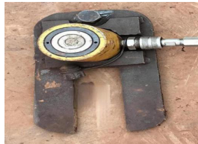
图1 自制千斤顶底座
