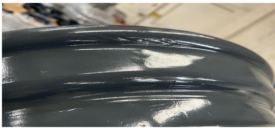
图2 轮辋制造缺陷
