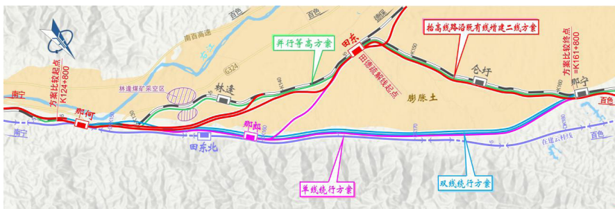
图 1 那何至那宁段穿越膨胀土地段方案示意图
