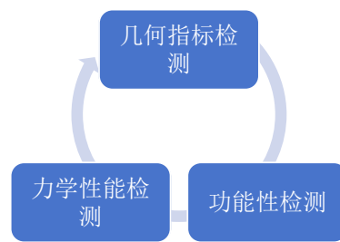
图 1 沥青路面成型后现场试验检测
