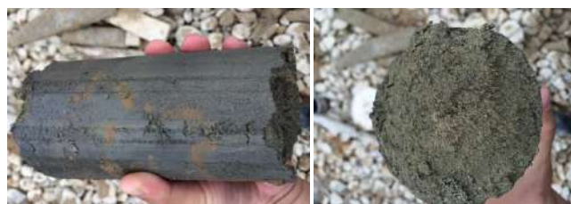
图2 砂层胶结成水泥砂浆
