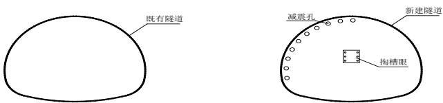
图 4 改变掏槽眼和减震孔的相对位置
