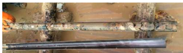
图3 砂卵石层改性成为混凝土
