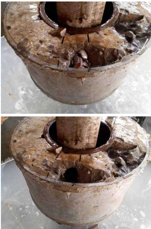
图8 优化设计后 139.7mm P110 套管固水泥室内磨铣试验
