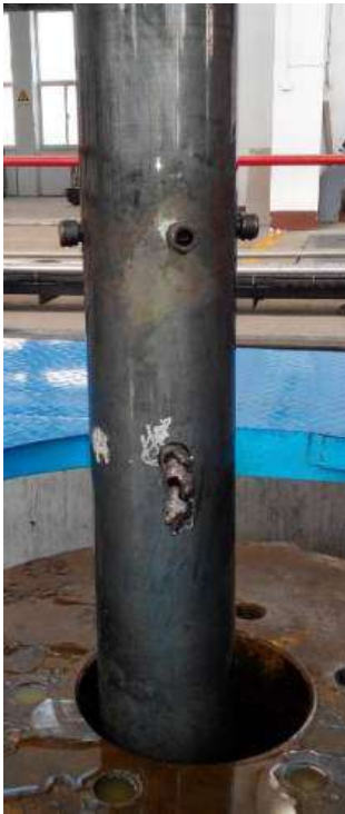
图7 优化设计后的磨铣套管试验
