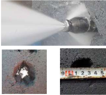
图 11 55Mpa 喷射破岩试验
