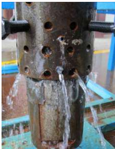
图5 使用改进后的钻头套管磨铣试验
