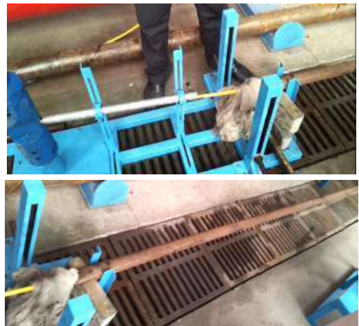
图9 室内自进试验
