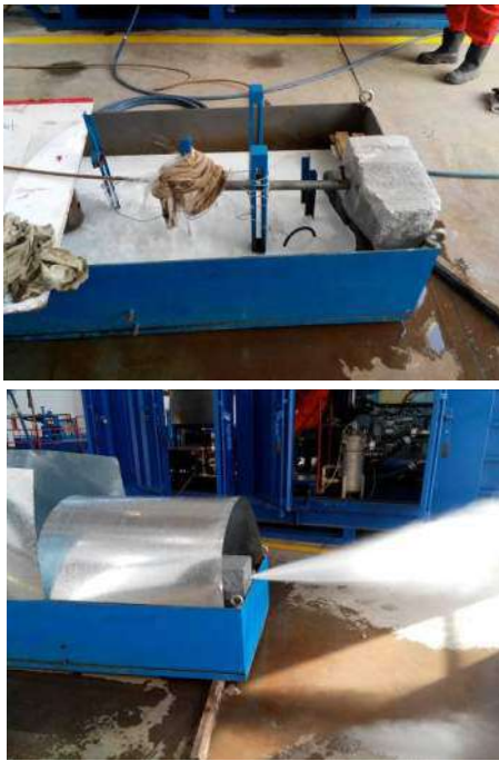
图 12 35Mpa 喷射破岩试验
