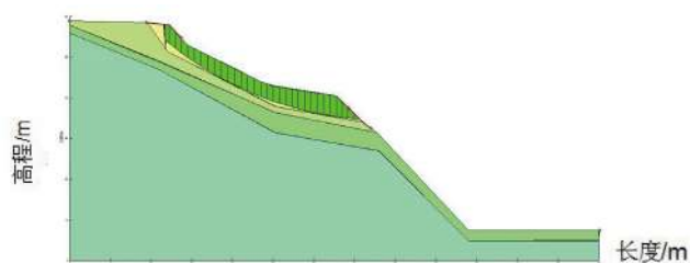
图 4 暴雨工况下 Janbu 法稳定性分析成果图
