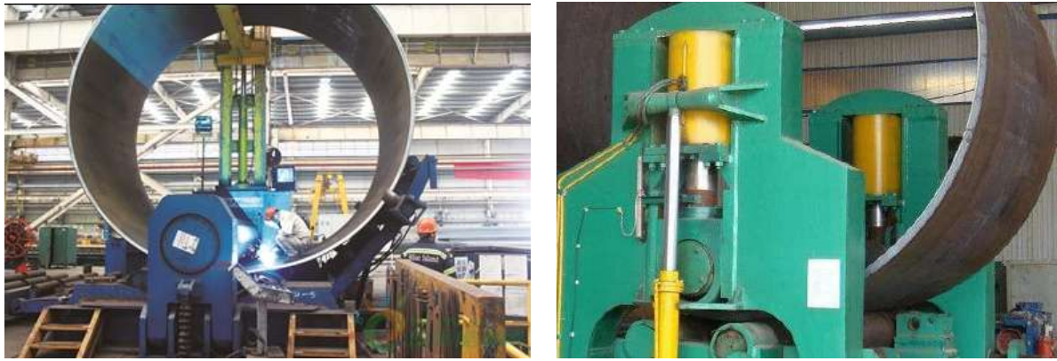
图1 卷板机卷圆成型工艺
