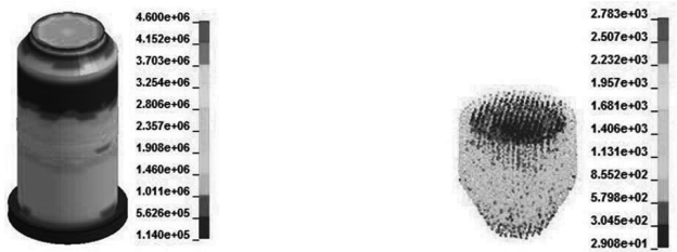
(d) 3/4 仓条件下筒仓及贮料有效应力云图
