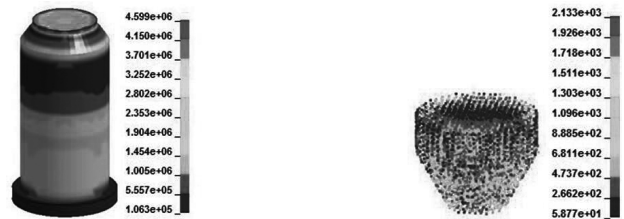
(c) 1/2 仓条件下筒仓及贮料有效应力云图
