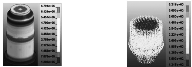
(e) 满仓条件下筒仓及贮料有效应力云图
