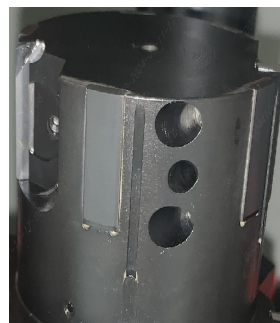
图 2 PCD 导条无积屑瘤
