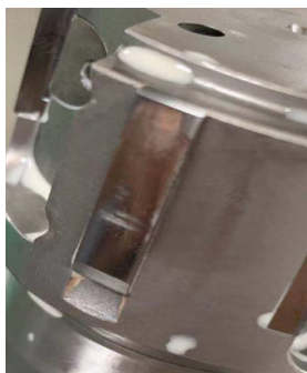
图 1 硬质合金导条有积屑瘤产生
