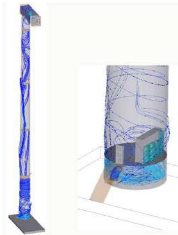
图7 优化后的塔筒内流场图
