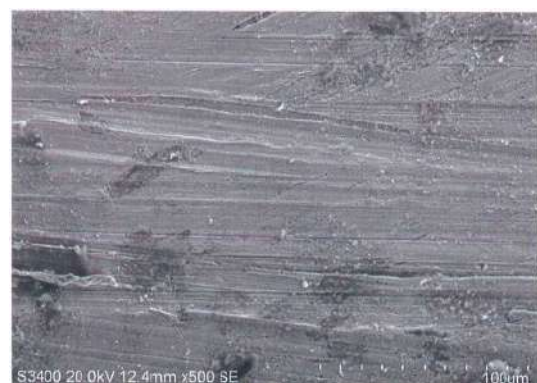
图 9 断面 A 区附近外表面微观形貌 1
