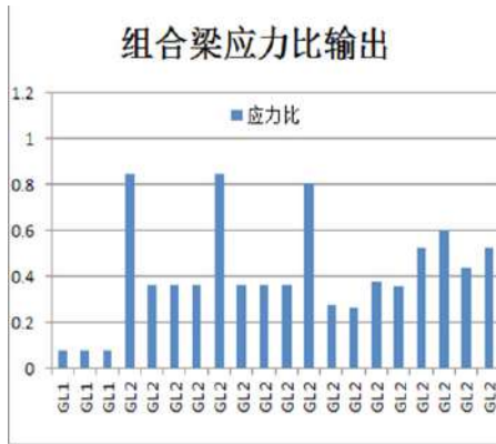
图 14 刚组合梁应力比 (施工荷载包络)
