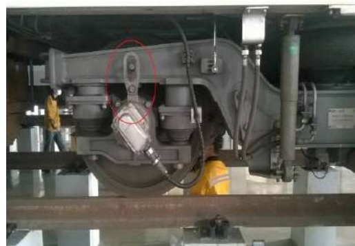
图2 轮对提吊安装位置实物
