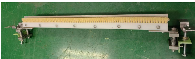
图 3 柔性托辊清洁装置安装示意图
