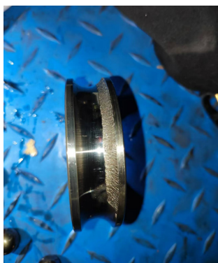
图 1: 推力轴承内圈磨损图
