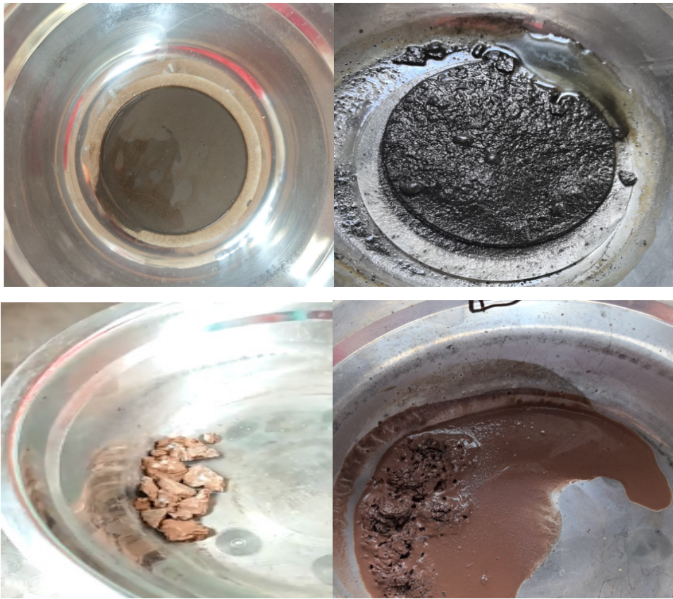
图 1 8% 氢氟酸酸液体系下泥饼与岩屑的溶蚀效果
