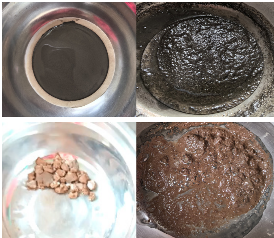
图 2 12% 盐酸酸液体系下泥饼与岩屑的溶蚀效果
