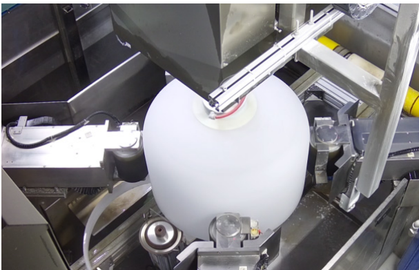
图 7 试验机台切割坩埚图片
