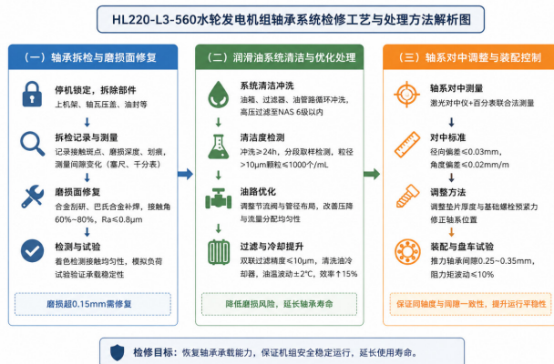
图1 HL220-L3-560水轮发电机组轴承系统检修工艺及处理方法解析
