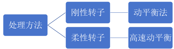
图2：转子不平衡处理方法
