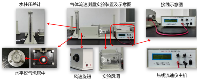
图 1 气体流速测量实验装置
