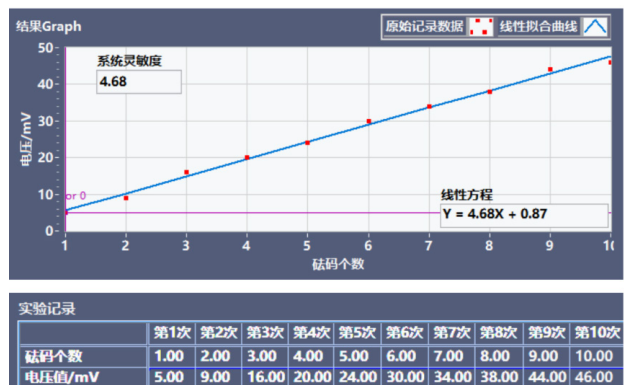
图5 单臂电桥实验记录
