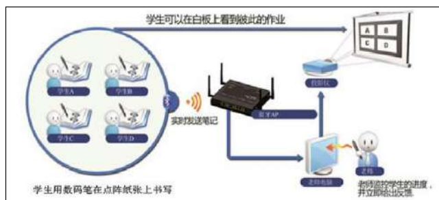
图6 点阵笔的基本信息传导流程图
