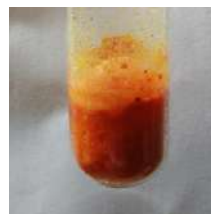
图 3 Cr_2O_3 与熔融的 KClO_3 反应得到橙红色混合物
