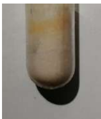
图 2 V_2O_5 与熔融 KClO_3 进一步反应生成接近白色 KVO_3
