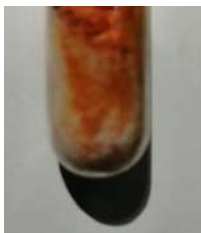
图 1 VO_2 与熔融 KClO_3 反应生成砖红色的 V_2O_5
