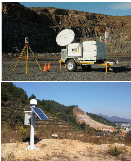
边坡雷达监测与 GNSS 监测设备照片
