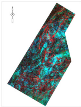
图7 Y 工区低中高频 RGB 融合断裂分布图
