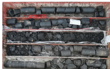
图 2 8-4 孔中 11 煤顶板的腐泥质泥岩
